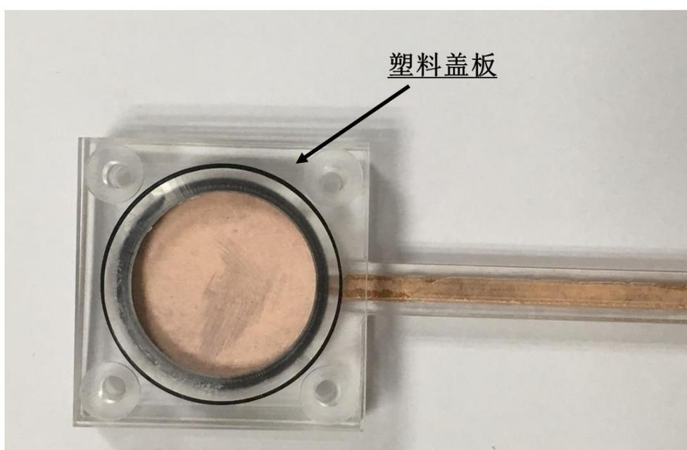
5. 拧上螺丝，如下图所示。由于密封圈比较柔软，螺丝不需要拧太紧即可良好密封。
