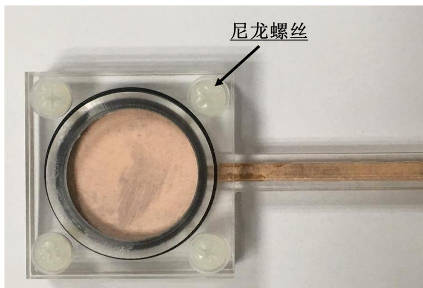
6. 安装好之后即可进行电化学沉积实验。下图为一个简单的例子，采用双电极法，正极接镍板，负极接安装了 AAO 的支架，将镍电沉积液倒入容器中（图中未倒入电沉积液），实时检测电流，即可进行电沉积镍。
